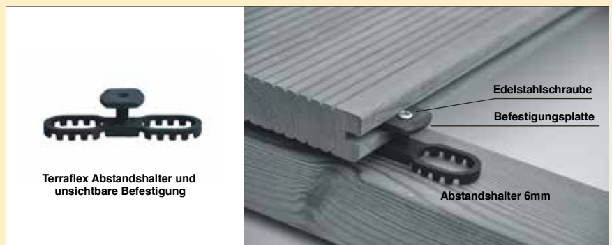
Bild 12: Anwendung Terraflex. Abstandshalter und unsichtbare Befestigung in einem Bauteil
